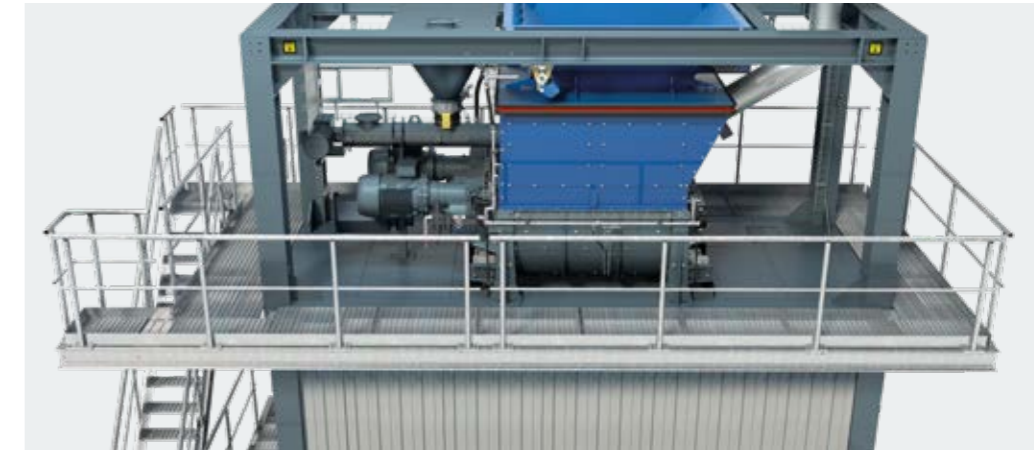
Sehr gute Zugänglichkeit in alle Bereiche durch umlaufende 800 mm Lauf- und Arbeitsbühnenbreite
