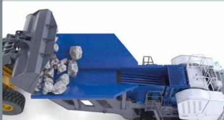
Chargement facile par chargeuse sur pneus possible, largeur de chargement à l'arrière 4 m
