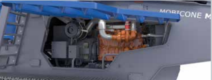
Buen acceso para trabajos de mantenimiento
