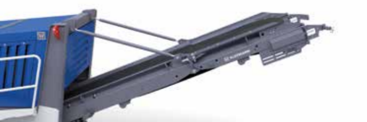
Cinta de descarga de la machacadora
