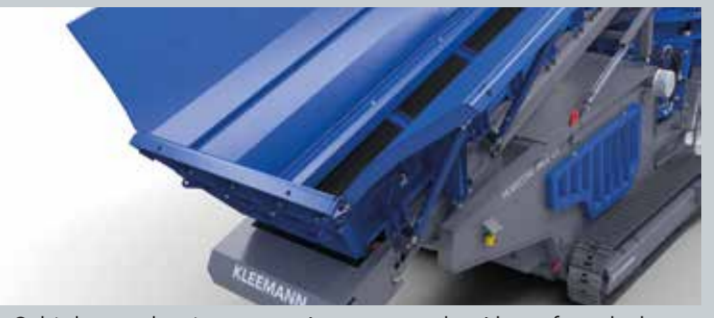
Schiebemechanismus zur Anpassung der Abwurfparabel
