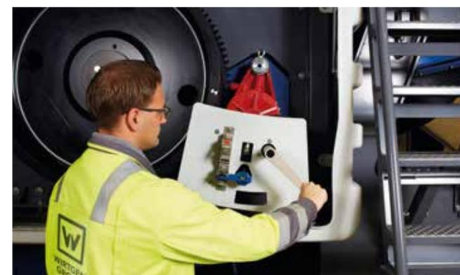
> La manivela hace girar el rotor de forma segura y lo coloca en la posición óptima para cambiar los barrones.
