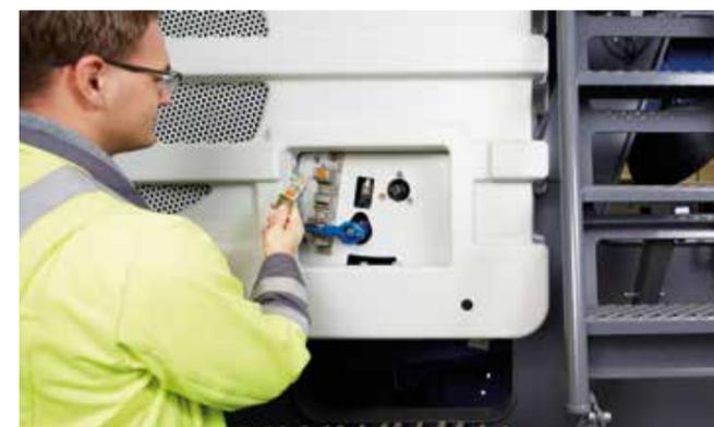
> Si se retiran las llaves, el rotor permanece asegurado de forma fiable.
