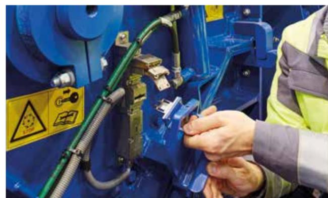
> El alojamiento de la machacadora se abre con una llave especial. Cuando se abre, la llave no se puede extraer y el material se puede retirar con seguridad.
