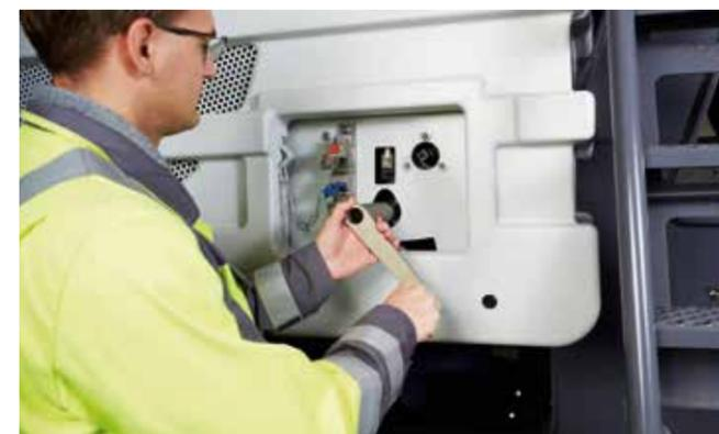
> El dispositivo de bloqueo del rotor y de giro está activado y puede moverse con una manivela.
