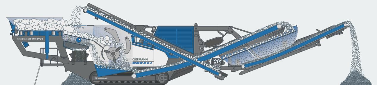
Die MOBIREX MR 110(i) EVO2 überzeugt mit ihrem optimalen Materialflusskonzept: Dabei sind die Systembreiten über die ganze Anlage in Materialflussrichtung erweitert - so wird der Materialstrom nicht eingeeengt und Materialverbrückungen können effektiv vermieden werden. Das Continuous Feed System erleichtert die
