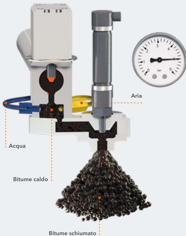
Tramite l'iniezione controllata dell'aria compressa e dell'acqua nel bitume caldo viene prodotto il bitume schiumato.
