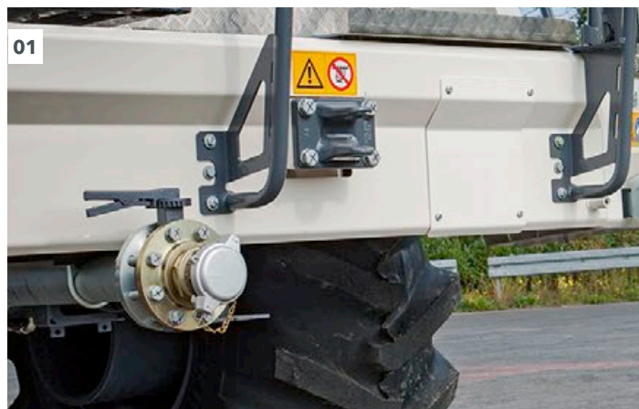
01 A conexão da mangueira encontra-se na travessa dianteira.
