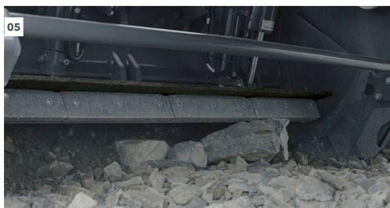
03 As barras trituradoras das abas de britagem fixas e variáveis, cada uma equipada com carboneto, servem como uma barra de contracorte para as ferramentas de trituração HT18 e, assim, permitem que a rocha seja britada.
