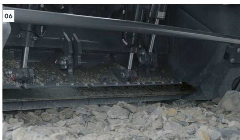
04 A rocha grossa se acumula na frente da tampa de entrada. 05 A tampa de entrada é aberta manualmente, e a rocha é empurrada para o compartimento de trituração e mistura à medida que passa por ela. 06 A tampa de entrada é fechada para minimizar a ejeção para a frente.
