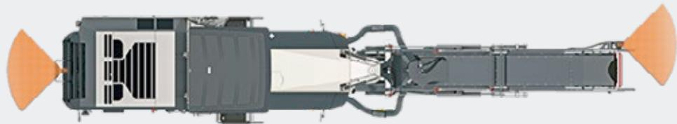
**Dispositif vidéo à 2 caméras :** caméra arrière / caméra chargement
