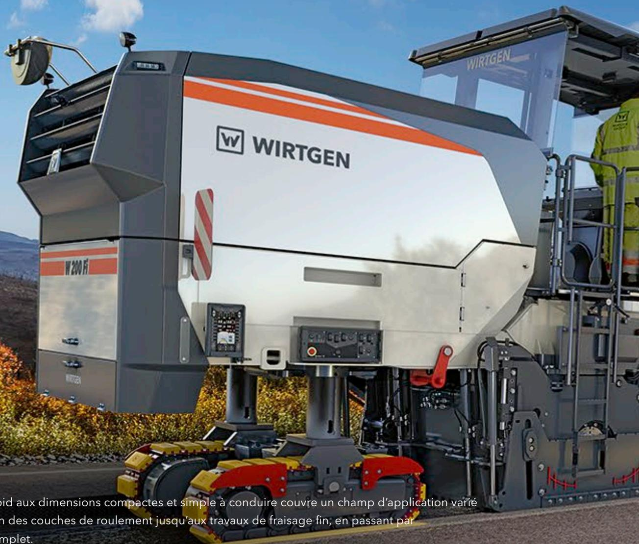
Cette fraiseuse à froid aux dimensions compactes et simple à conduire couvre un champ d'application varié allant de la réfection des couches de roulement jusqu'aux travaux de fraisage fin, en passant par le décaissement complet.
