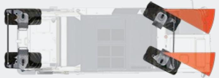
Les roues arrière restent automatiquement en position droite, mais peuvent être dirigées séparément en utilisant la manette
