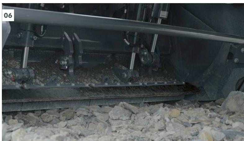
**04** Des graves grossières s'accumulent devant le tablier d'entrée. **05** Le tablier d'entrée est ouvert manuellement et les graves sont poussées dans le bâti de concassage et malaxage lors du nouveau passage. **06** Le tablier d'entrée est fermé pour minimiser l'éjection vers l'avant.
