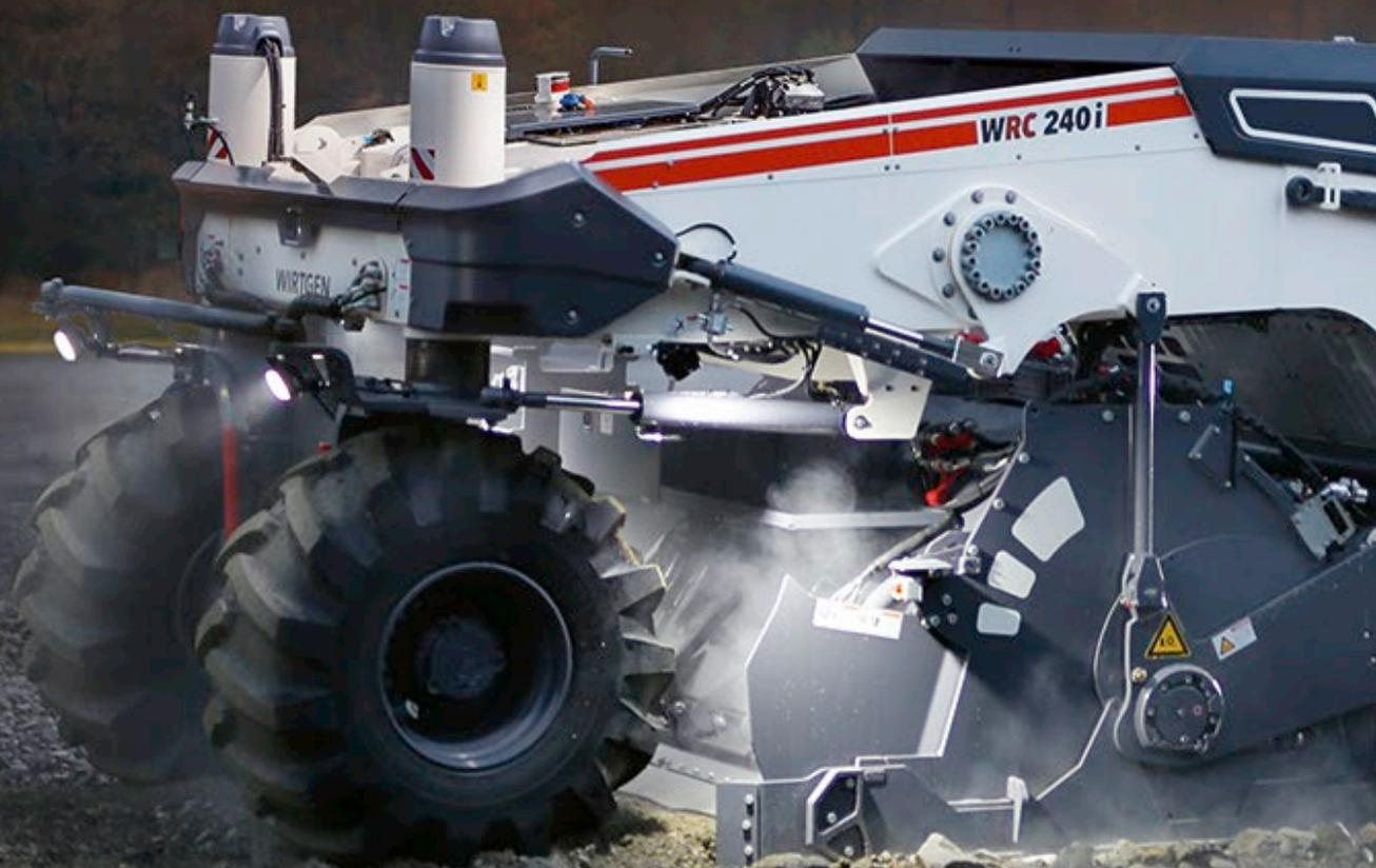
L'innovant Rock Crusher, avec sa puissante unité de concassage, de criblage et de malaxage, assure le concassage, le retraitement ainsi que l'homogénéisation des fondations en pierres, des fragments de béton, des pavés ou des graves avec une productivité allant jusqu'à 600 t/h.
