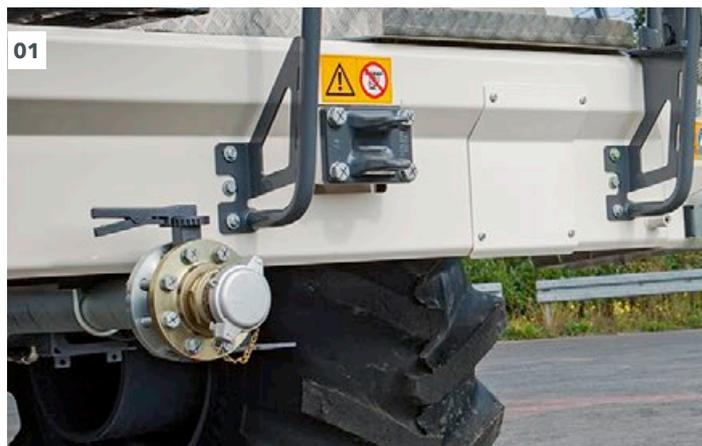
01 Le raccord des flexibles se trouve sur la traverse avant.
