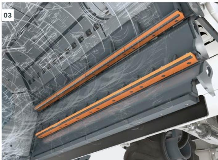
**03** Les barres de concassage dotées de métal dur des niveaux de concassage fixes et variables servent de contre-tranchant pour les outils de concassage HT18 et permettent ainsi le concassage des graves.
