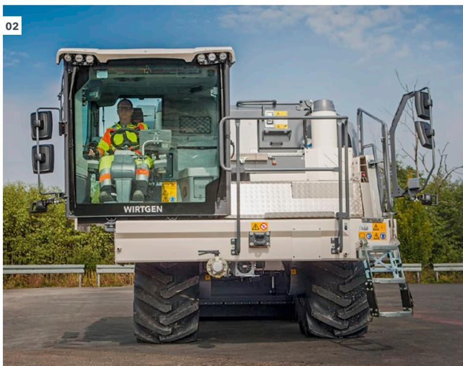
**01 - 02** Pour pouvoir voir au-delà d'un atelier de recyclage roulant en amont, la cabine est déportée à droite par commande hydraulique.
