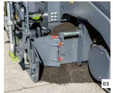
スクリード前方の横方向への合材供給により、あらゆる舗装状況において最適な合材供給が可能です。コンベアとオーガ用の強力な独立油圧式駆動装置により、最大1,100トン/時の高い舗装率を実現しました。コンベアとオーガの制御信号が組み合わせられ、合材の送り出しを均一にし、合材を安定して供給できます。これにより、負荷ピークを回避するだけでなく、燃料消費量も削減できます。
