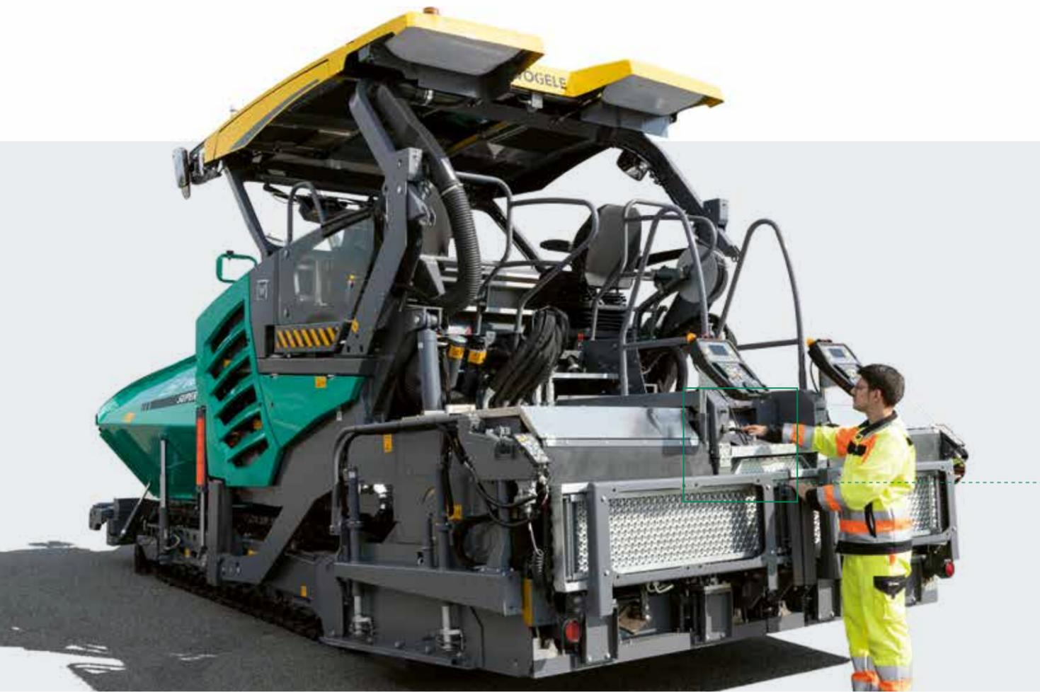
暗くなったら、まずペーバの照明スイッチを入れます。カバーを開けたら、ディーゼルエンジンを始動し、ルーフを上げ、スクリッドを下げて、快適にステップを登ることができます。
