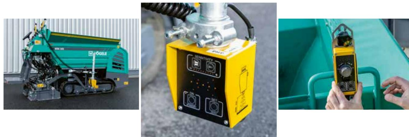
L'obiettivo è ottenere la massima planarità anche su opere viarie strette. Per la MINI 500 e la MINI 502, VÖGELE propone un dispositivo di livellazione automatica facilissimo da usare. Le funzionalità sono coordinate all'ambito di impiego delle
