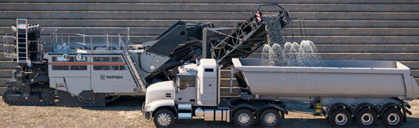
**01** Un rociado con agua en la cinta de descarga reduce la formación de polvo al cargar rocas secas.
