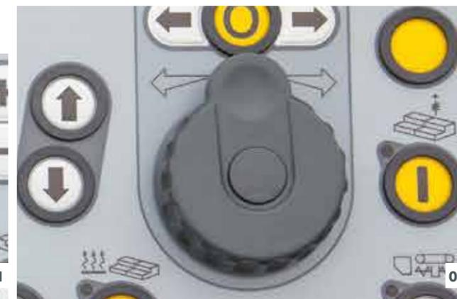
01 Con solo pulsar un botón, la extendedora cambia entre los modos de servicio "Extendido", "Posicionamiento", "Desplazamiento obra" y "Neutro".
