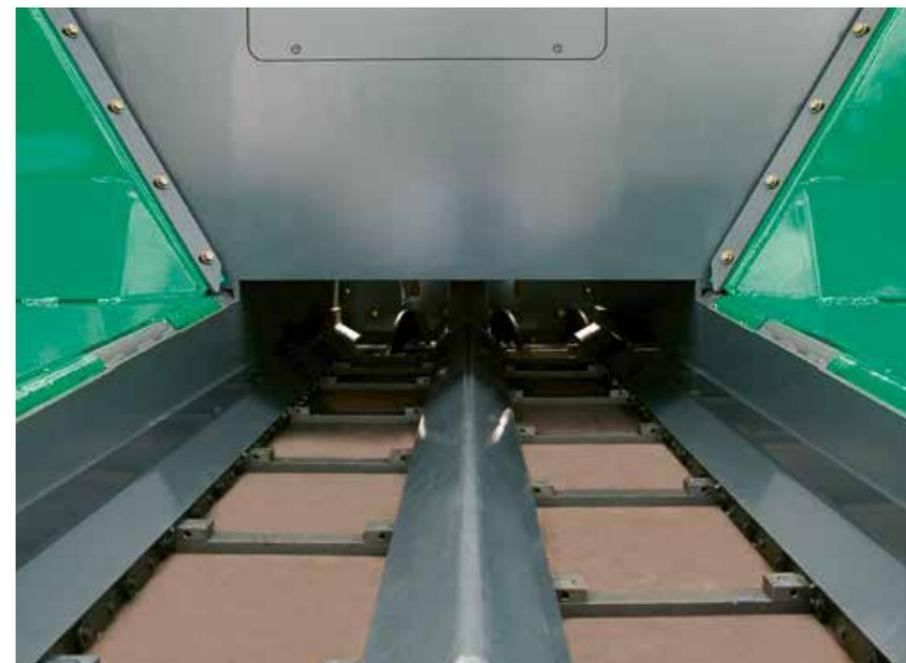
La marcha de la cinta transportadora puede invertirse con solo pulsar un botón. El retorno de la mezcla se detiene automáticamente. Y con la misma rapidez se puede poner la cinta transportadora en la función de marcha en vacío.
