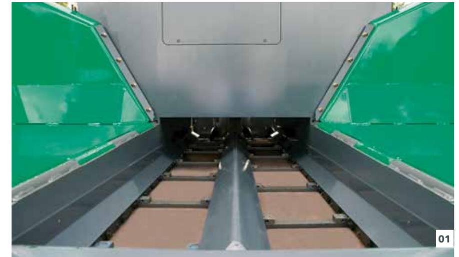
El transporte de material posterior y la distribución homogénea frente a la regla son óptimos, gracias al gran túnel de material, las cintas transportadoras regulables proporcionalmente y el potente sinfín de distribución.
