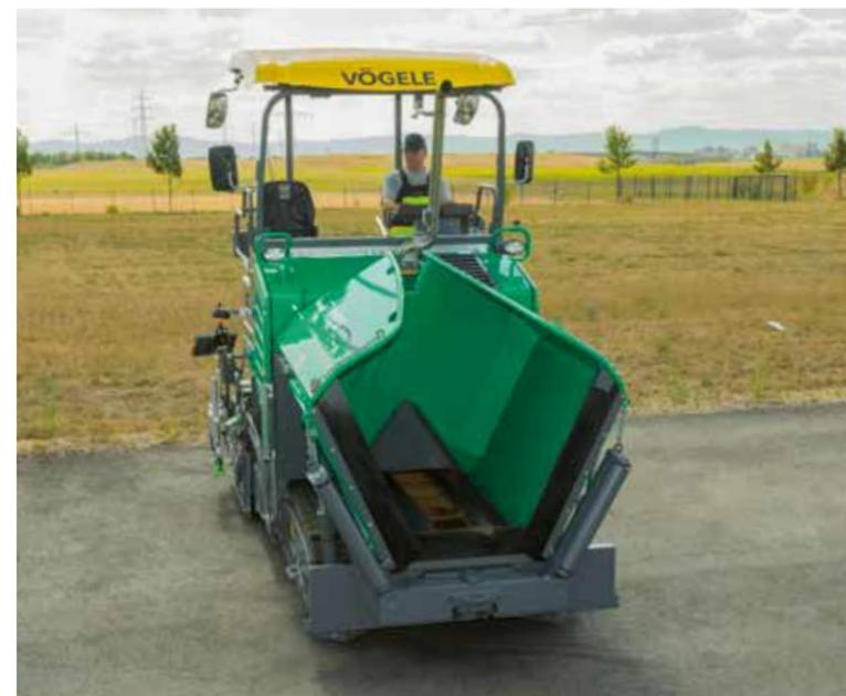
Plegando hacia arriba las paredes de la tolva también se pliegan los rodillos de empuje del camión.
