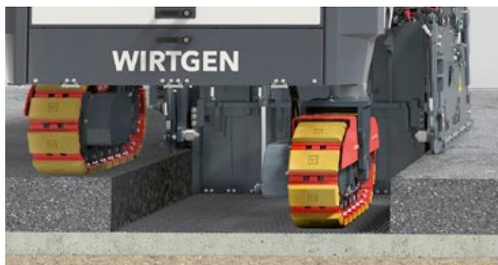
Gruppo di fresatura FB1500 con Multiple Cutting System **MCS BASIC**.
