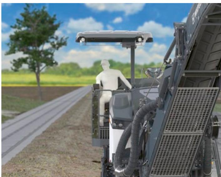
Il tettuccio di protezione, regolabile verticalmente e lateralmente, offre una protezione ottimale in varie posizioni di lavoro, soprattutto in condizioni di cantiere ristrette.
