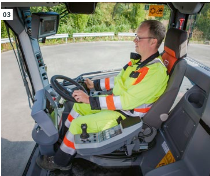
03 - 04 El asiento confortable con posibilidad de ajuste individualizado coloca al maquinista en la posición ideal.
