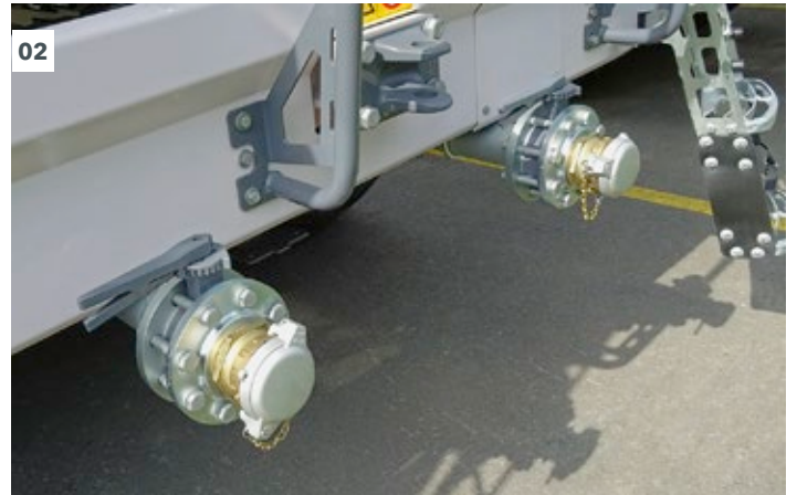
02 Las conexiones para el agua y la emulsión están en un lugar bien accesible.
