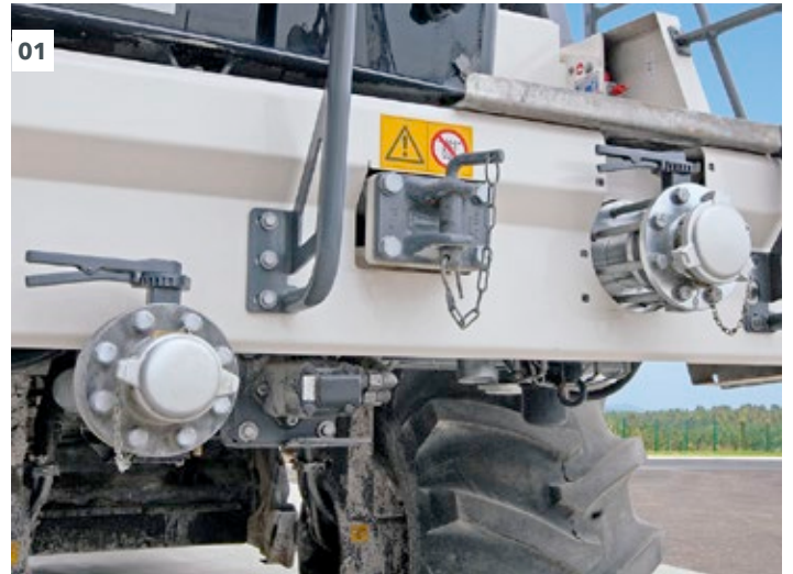
01 El pitón de conexión de betún espumado está en un lugar fácilmente accesible.
