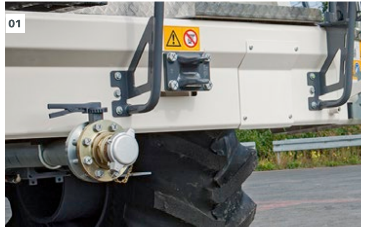
01 Todas las conexiones de manguera están dispuestas en el travesaño delantero.
