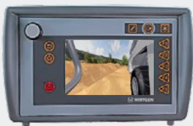
Cámara en el lado izquierdo de la máquina
