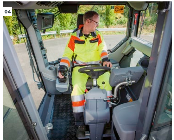
03 - 04 El asiento confortable con posibilidad de ajuste individualizado coloca al maquinista en la posición ideal.
