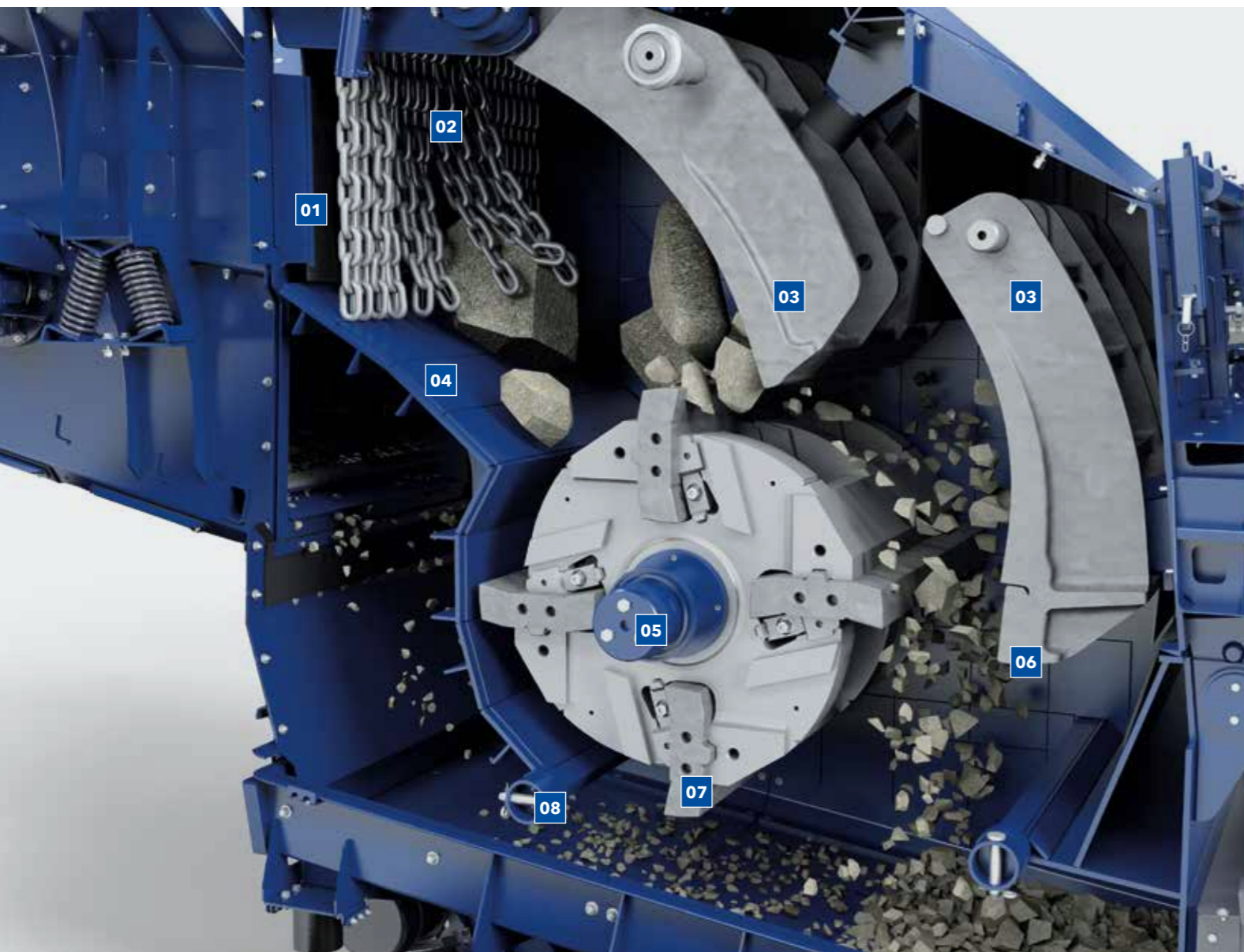
Superfície de placas no interior do britador. As fendas são um pré-requisito para a dureza ideal.
