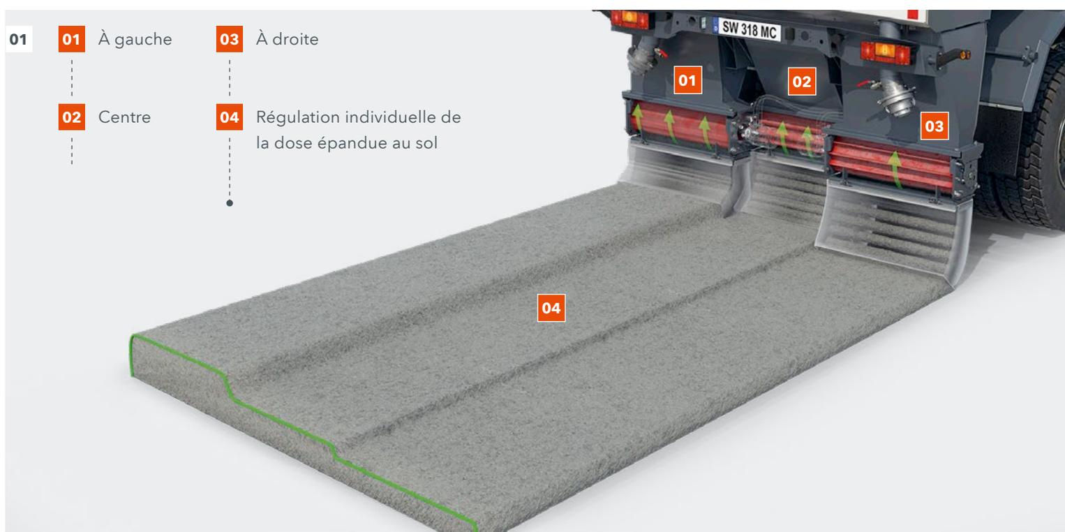
**01** L'épandage par sections permet d'exclure quasiment tout chevauchement du matériau à épandre.
