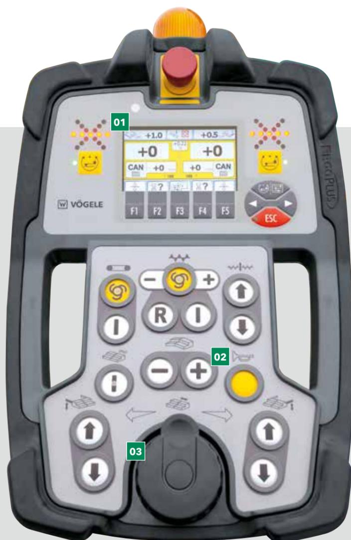
**01** La pantalla a color de gran contraste hace posible una legibilidad clara, también con malas condiciones luminosas. Además, la iluminación LED de alto rendimiento facilita la visibilidad óptima de todos los procesos en torno a la placa limitadora lateral también en la oscuridad.
