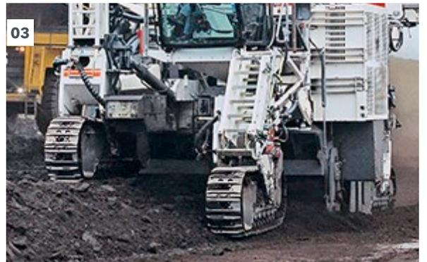
02-03 As quatro esteiras possuem ajuste individual de altura, através de cilindros hidráulicos.
