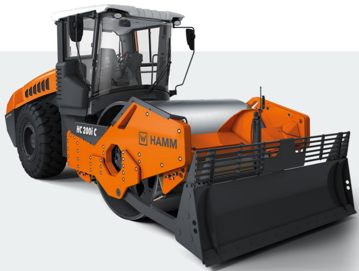
Düz veya keçi ayağı tamburlu 20 tona kadar makineler için dozer bıçağı vardır.
