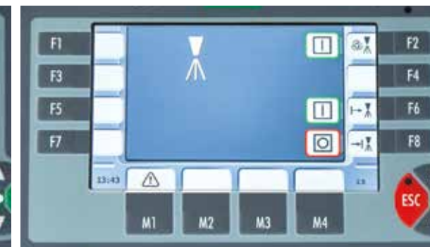
Функции „Начало полосы“ и „Конец полосы“ Для того чтобы процесс разбрызгивания начинался либо заканчивался в точно намеченном месте по всей рабочей ширине существуют функции комфортного управления „Начало полосы“ (F6) и „Конец полосы“ (F8).
