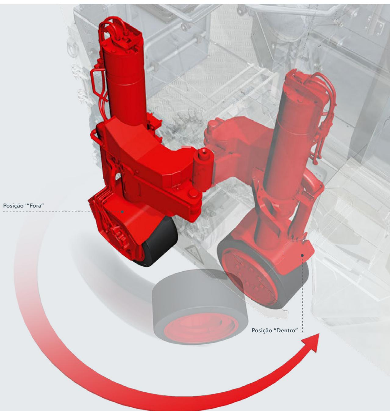
A roda traseira direita giratória permite uma fresagem precisa ao longo de obstáculos, como cantos de meios-fios ou muros.
