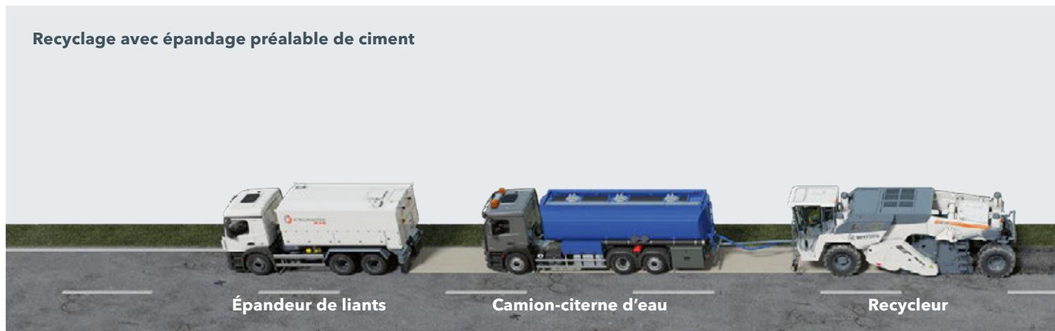
Recyclage avec ciment répandu au préalable et émulsion de bitume
