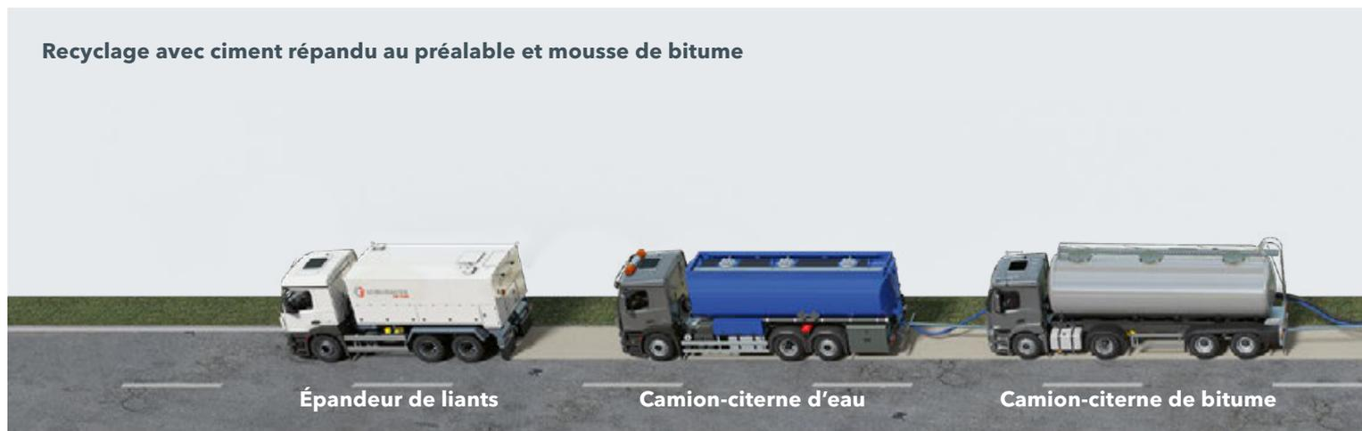
Pour la réalisation d'une couche de base stabilisée aux liants hydrauliques, un épandeur de liants Streumaster répand une couche de ciment, suivi d'un camion-citerne d'eau. Le puissant rotor de fraisage et de malaxage du WR concasse les couches endommagées. Dans le même temps, du ciment
