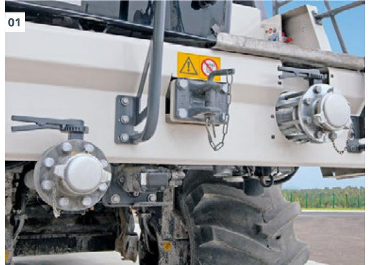
01 Le raccord pour la mousse de bitume est facilement accessible.
