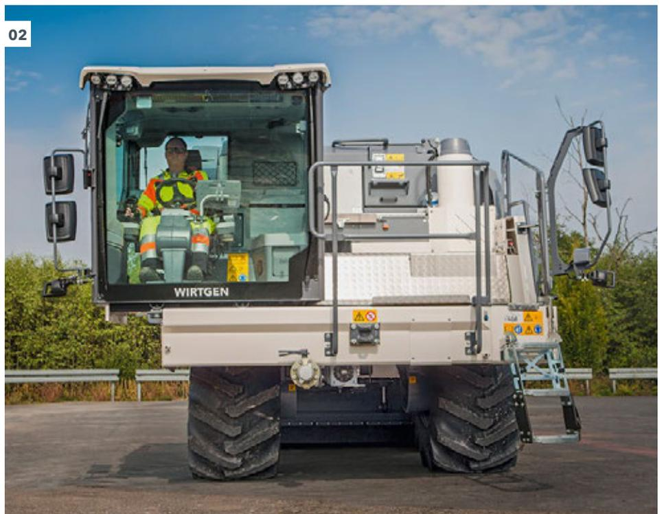
01 - 02 Pour pouvoir voir au-delà d'un train de recyclage roulant en amont, la cabine est déportée à droite par commande hydraulique.
