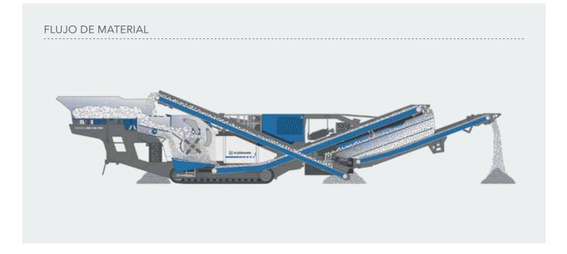
MOBIREX MR 130(i) PRO convence por su calidad de producto óptima y alto rendimiento de producción. Además, el Continuous Feed System CFS permite un flujo continuo de trituración del molino. Mediante el sistema de ajuste de la distancia totalmente hidráulico, los parámetros de la máquina pueden adaptarse rápidamente a la aplicación. El sistema de sobrecarga ofrece una protección eficaz de la machacadora y una elevada
