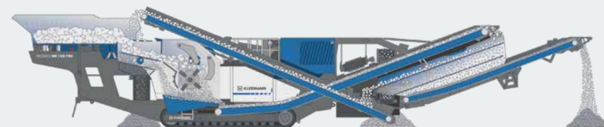
A planta MOBIREX MR 130(i) PRO convence com qualidade máxima do produto e capacidades de produção muito altas. Simultaneamente, o Continuous Feed System CFS assegura uma alimentação contínua do britador. O ajuste da abertura totalmente hidráulico permite adaptar rapidamente os parâmetros da máquina à aplicação. O sistema de sobrecarga oferece uma proteção eficaz do britador e uma alta disponibilidade da
