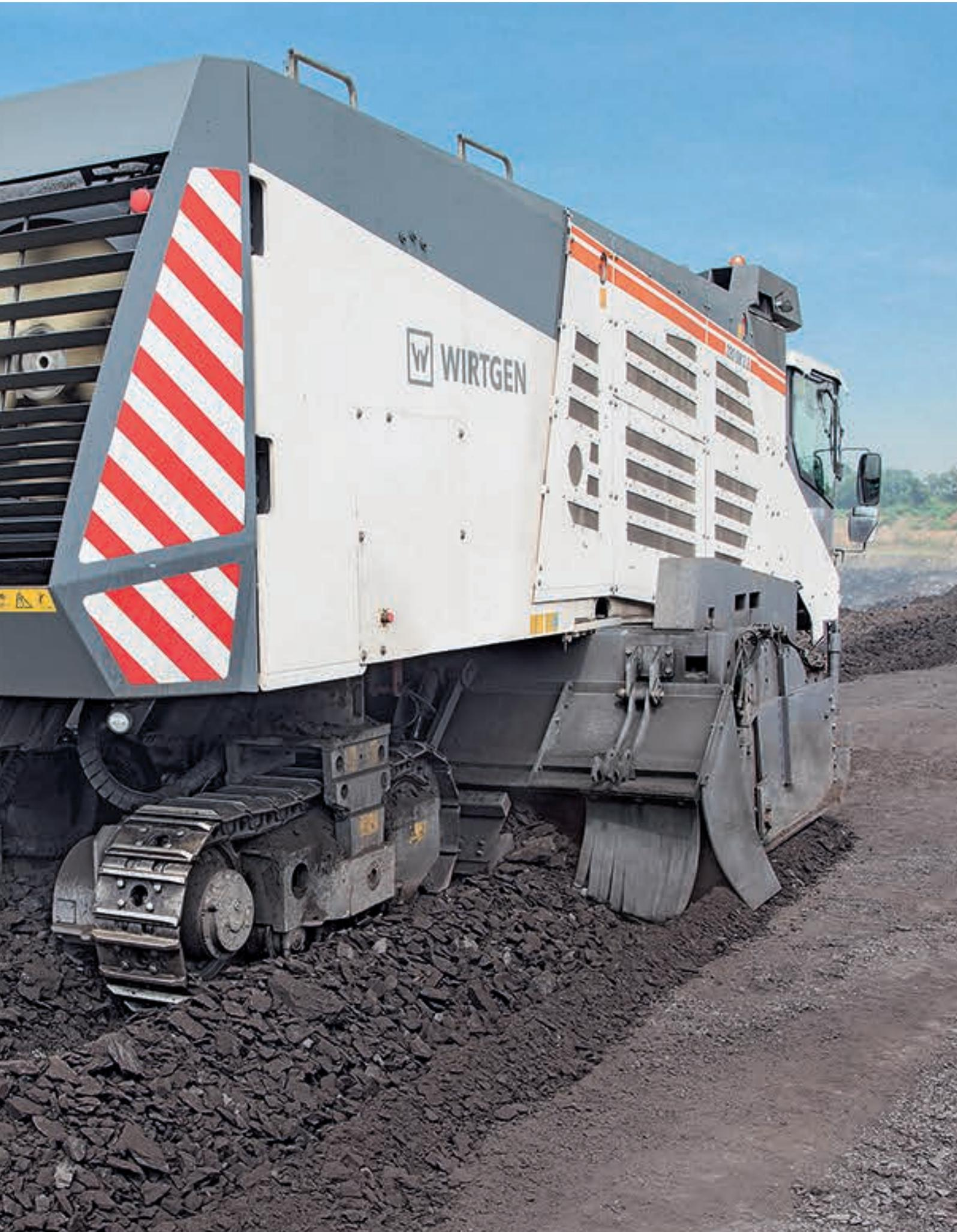
Das optimal für Weichgesteinabbau ausgelegte 3,8-m-Schneidwalzenaggregat des 220 SM(i) 3.8 garantiert maximale Produktivität bei minimalen Betriebskosten. Der Surface Miner gewinnt Rohstoffe selektiv mit bis zu 350 mm Schneidtiefe. Der kompakte 220 SM(i) 3.8 ist für den Einsatz in Bergbaubetrieben jeglicher Größenordnung prädestiniert.
