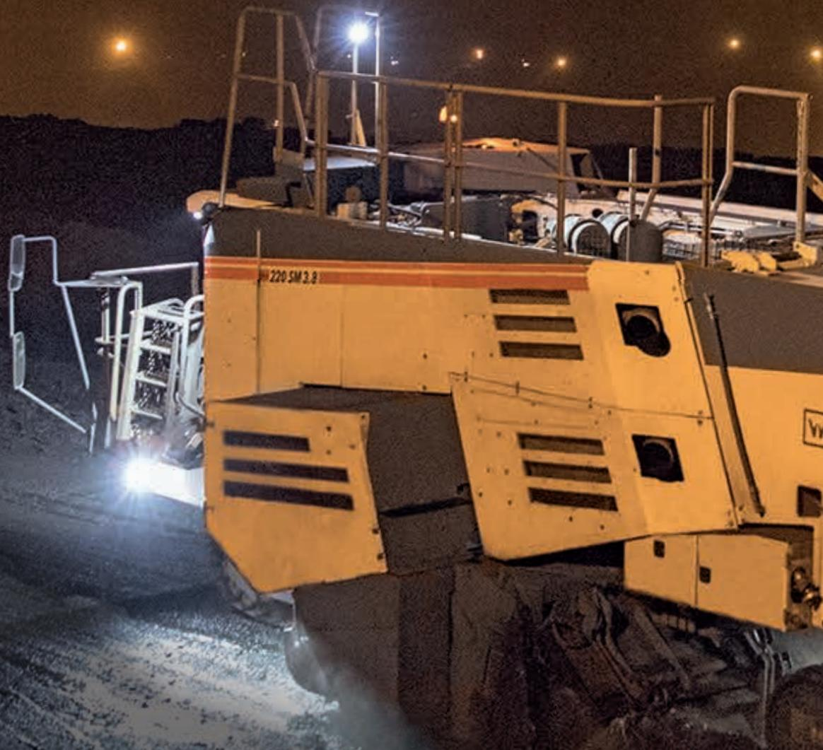
Das optimal für Weichgesteinabbau ausgelegte 3,8-m-Schneidwalzenaggregat des 220 SM(i) 3.8 garantiert maximale Produktivität bei minimalen Betriebskosten.
