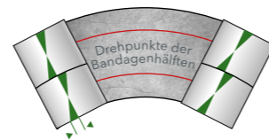
Um 50 % reduzierte Scherspannungen bei Verdichtung mit geteilter Bandage
