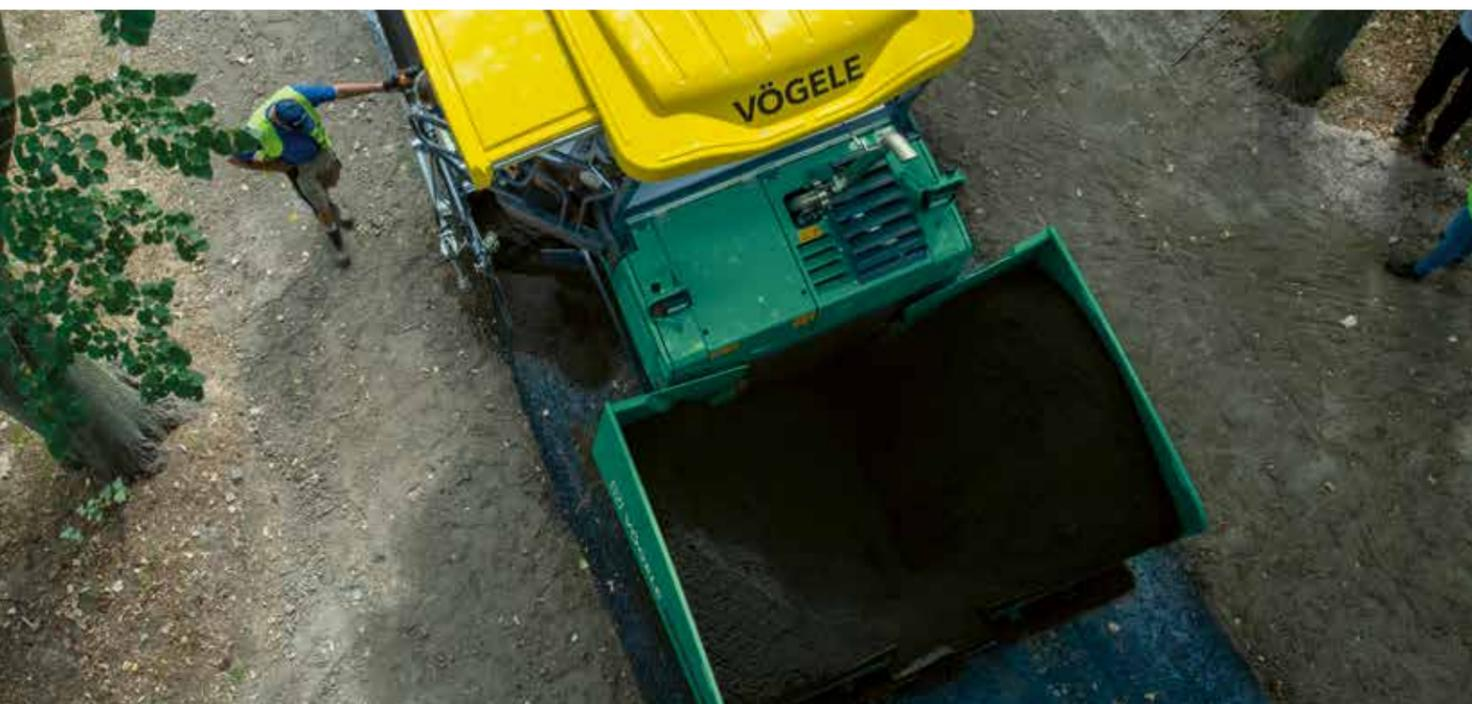
El transporte del material y la distribución homogénea frente a la regla son óptimos, gracias al gran túnel de material, las cintas transportadoras regulables proporcionalmente y el potente sinfín de distribución.
