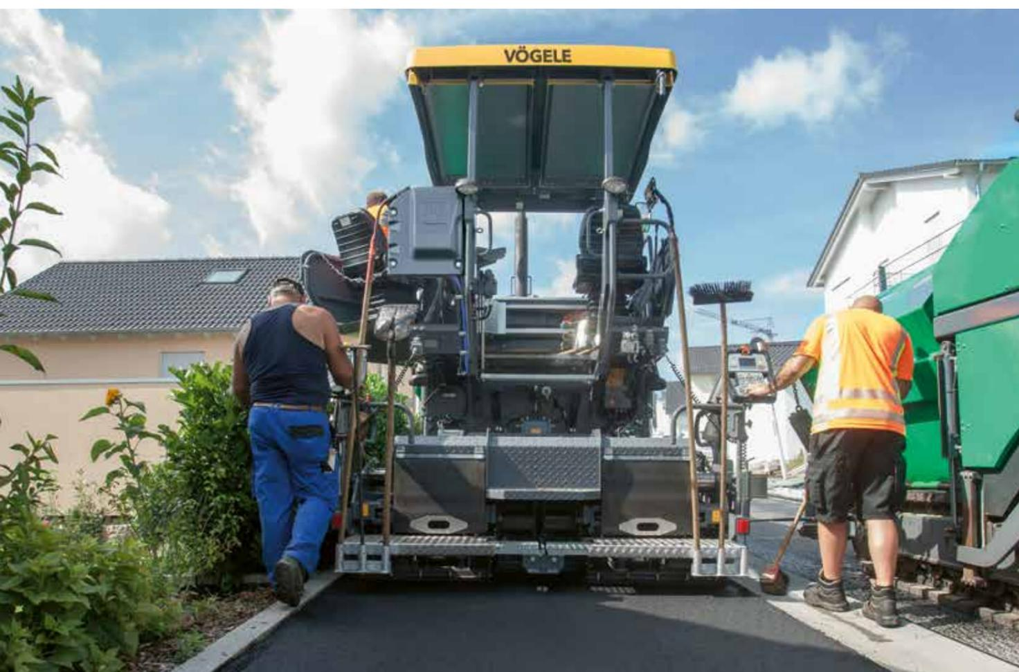
Para el transporte, el techo de plástico reforzado con fibra de vidrio, incluido el tubo de escape, puede plegarse hacia abajo con pocos movimientos. Así se puede transportar la extendidora de forma rápida y sencilla.
