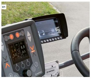
01 La posibilidad de abarcar con la vista las zonas de trabajo importantes a través de una cámara supone un aumento del rendimiento y de la calidad.
