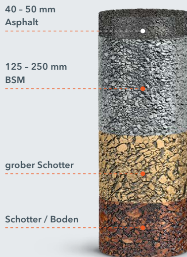
Straßenbau mit BSM (Beispiel)
