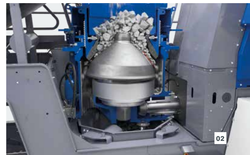
01 Passaggio del materiale 02 Regolazione fessura di frantumazione
