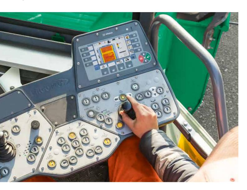
Le conducteur du finisseur interagit avec le module « chantier » via l'écran ErgoPlus 3. Il dispose ainsi à tout instant des informations actuelles sur le chantier et sur l'avancement des travaux. Grâce à des affichages clairs et aisément compréhensibles, il identifie immédiatement tout écart éventuel entre le réel et le planifié.
