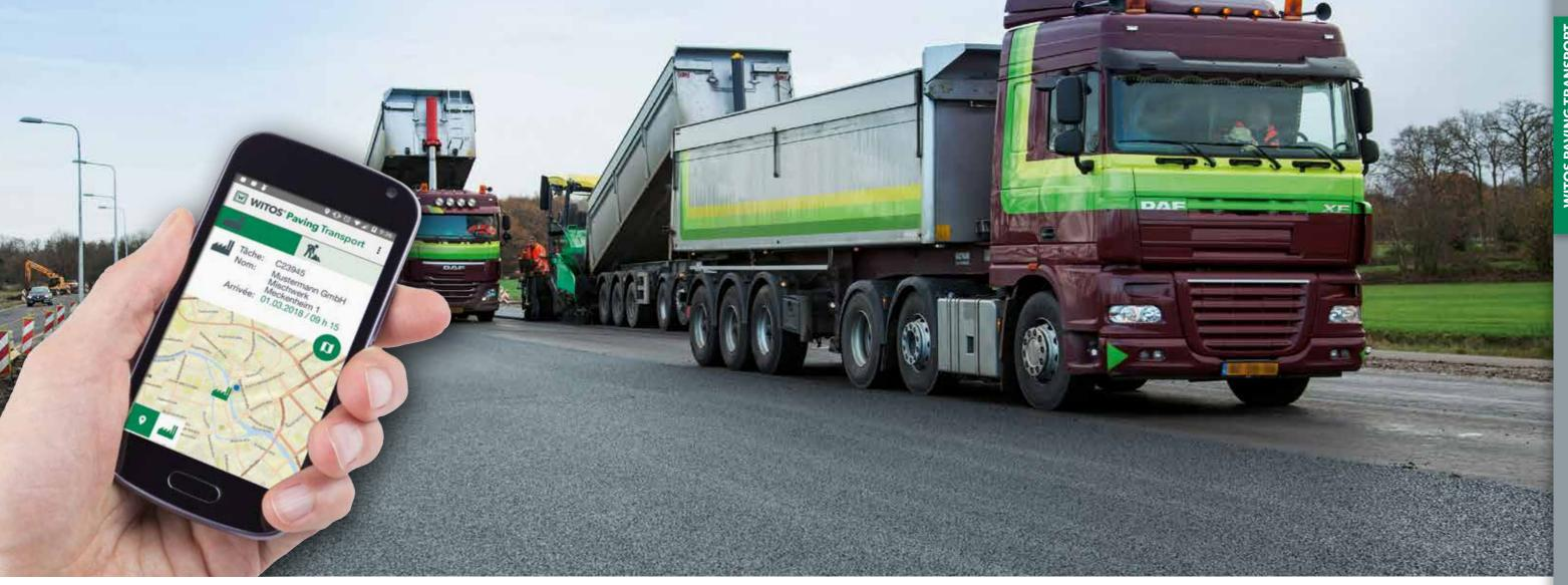
Grâce à WITOS Paving Plus, l'équipe de pose, le chef de chantier et la centrale d'enrobage sont informés en temps réel, pendant toute la phase de pose, de l'arrivée d'un camion d'enrobé sur le chantier. Cette information permet de gérer les travaux de manière beaucoup plus fiable qu'avant. Cette planification précise a aussi une influence sur la qualité de pose, car elle permet d'éviter efficacement les temps d'attente des camions et donc un refroidissement possible de l'enrobé.
