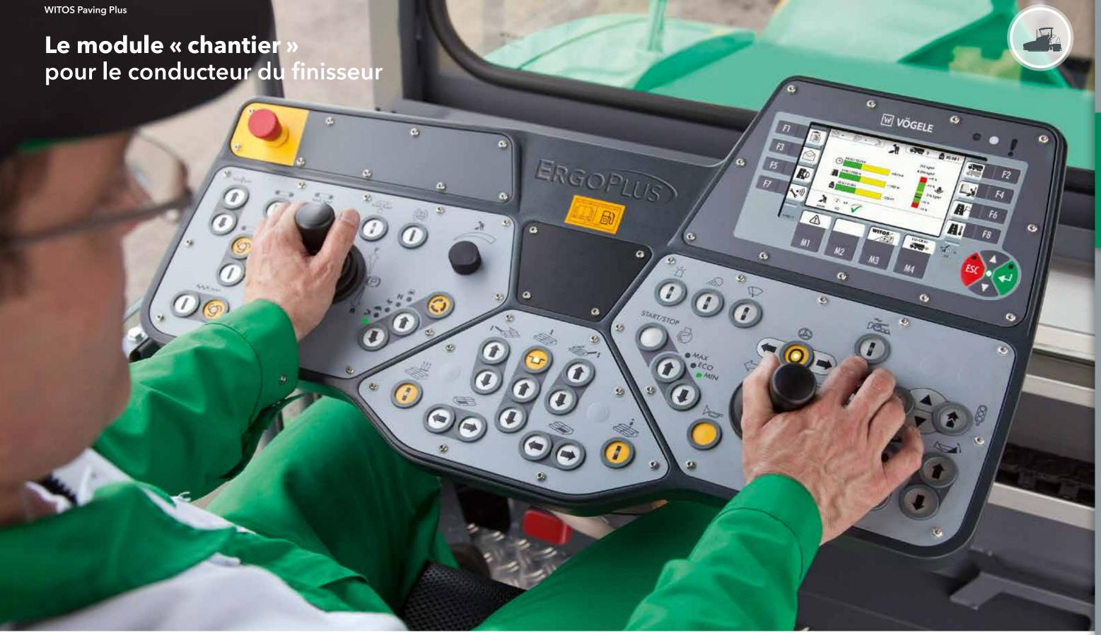
**Le module « chantier »** fait partie intégrante du système de conduite ErgoPlus 3 des finisseurs VÖGELE et offre au conducteur du finisseur un système unique de contrôle et d'optimisation des processus.
