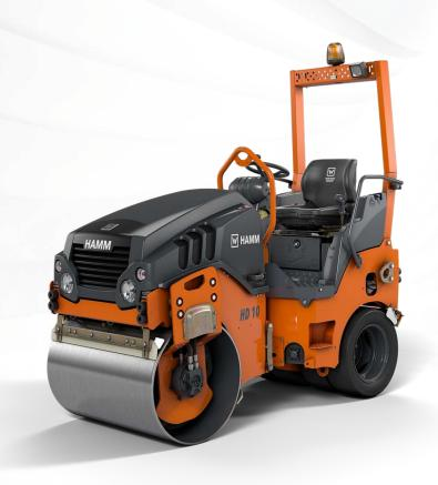
タンデムローラ シリーズ HD CompactLine バイブレーションドラムとホイールセット付きタンデムローラー H230
